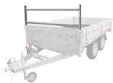
8 Front rail bolted / ladder rack, vordere Reling geschraubt, Porte échelle avant boulonné, reling przedni skręcany
